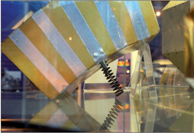
**Unterhalb von OSCAR I sieht man den Federmechanismus zum Lösen von OSCAR I aus dem Trägersystem**
